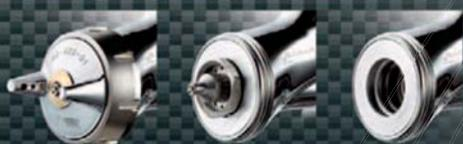
По-новому выполненная резьба на воздушном колпачке позволяет быстро заменить его и повышает стабильность – в результате Вам нужно будет реже заказывать запчасти. Благодаря большим насечкам на гайке воздушного колпачка Вам легче снимать его и быстрее навинчивать после промывки.
